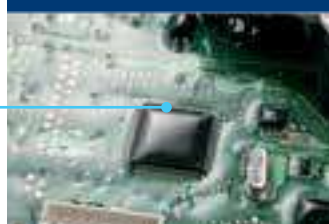
Superfície da placa eletrônica de controle utiliza tecnologia de encapsulamento SMT
